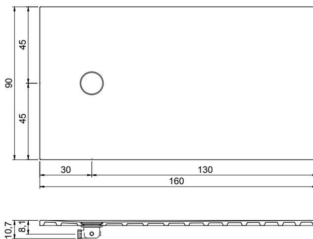
**!** Piletta specifica per piatti doccia collezione Foglio, poiché è stata progettata e realizzata specificatamente per il design e per il corretto funzionamento dei nostri piatti doccia, non è possibile utilizzare pilette alternative.
