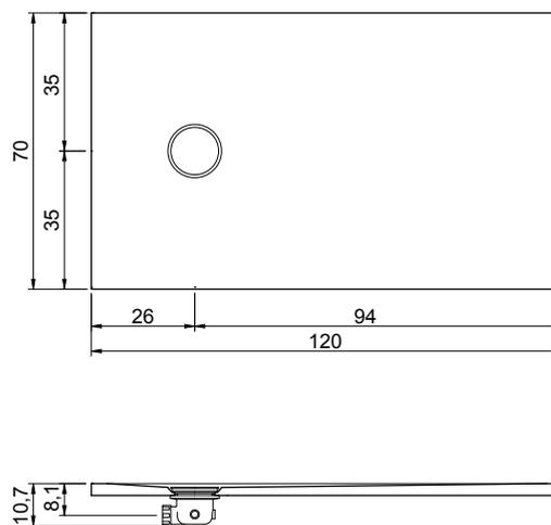
**!** Piletta specifica per piatti doccia collezione Plaid, poiché è stata progettata e realizzata specificatamente per il design e per il corretto funzionamento dei nostri piatti doccia, non è possibile utilizzare pilette alternative.
