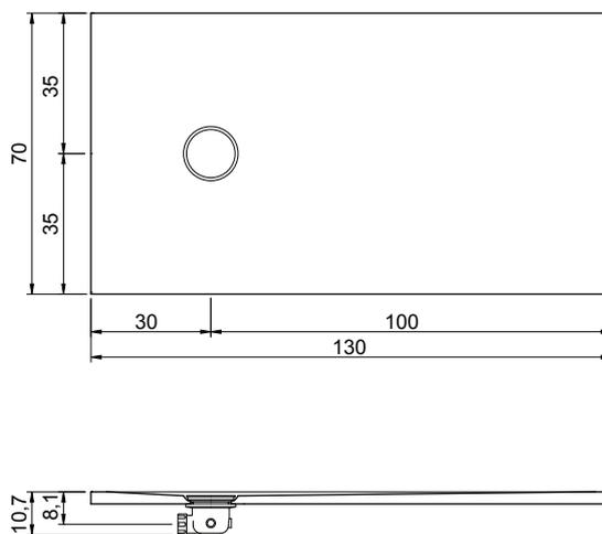
**!** Piletta specifica per piatti doccia collezione Plaid, poiché è stata progettata e realizzata specificatamente per il design e per il corretto funzionamento dei nostri piatti doccia, non è possibile utilizzare pilette alternative.
